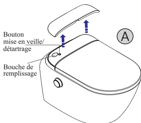
Pressez longuement sur le bouton
